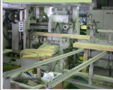
プレカット工場での能率的な製材、刻み作業の実施
